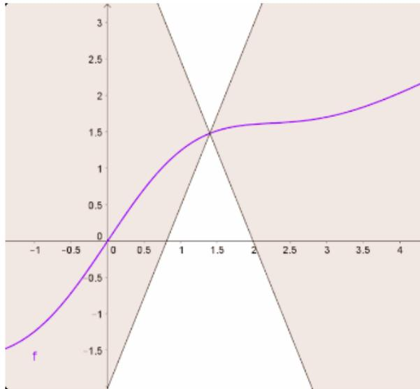
Für eine Lipschitzstetige Funktion existiert ein Doppelkegel (weiß), dessen Ursprung entlang des Graphen bewegt werden kann, sodass der Graph stets außerhalb des Doppelkegels bleibt.
